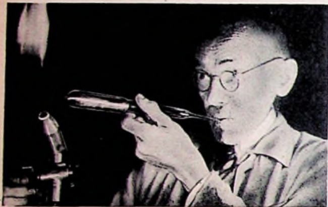
das zunächst auf der Quetschfußseite zugeschmolzen wird,
