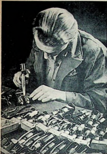
Abb. 2. Zusammenbau von Austauschkombinationen für die U-Serie Aufnahme Stumpf
